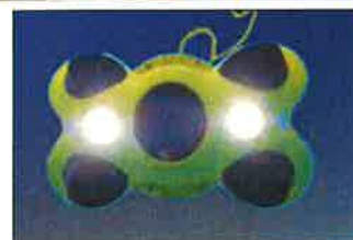
Fig. 3 MiniROV-farkosten, som använts vid botteninspektionen av området. Farkosten är försedd med 8 propellrar som medger manövrering i alla riktningar inklusive roll och pitch.
